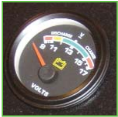
Battery volt meter
